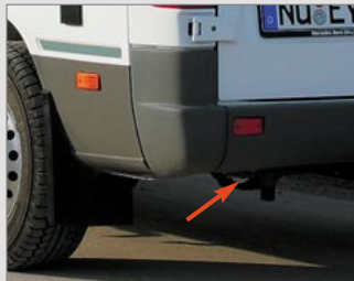
Entleerungsventil Abwassertank
