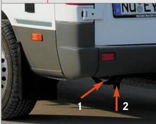
Abwassertank ca. 80 l: Entleerungsventil (1), Ablauföffnung (2)
