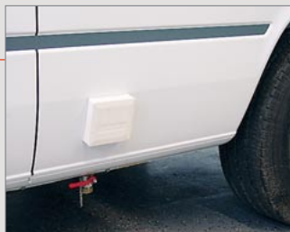
Kaminklappe der Gasheizung
