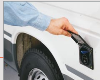
230-V-Einspeisung (CEE-Anschluss)
