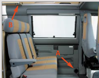
Ausströmöffnung (A) und Bedienteil der Gasheizung (B)
