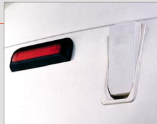
Kaminöffnung Warmwasserboiler
