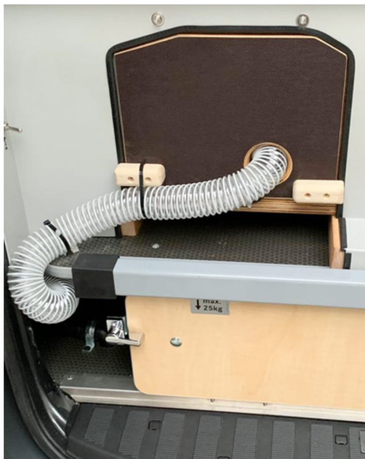
Die Ansicht durch die Hecktür mit dem Entlüftungsschlauch und Schalter für den Lüfter der ist wichtig für die Entfeuchtung.
