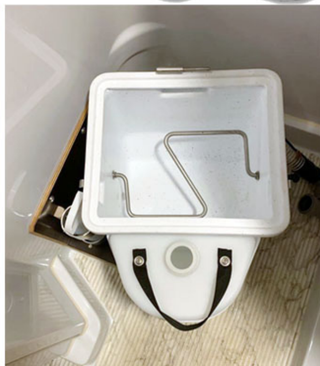
Den Unterbau mit den getrennten Tanks montieren
