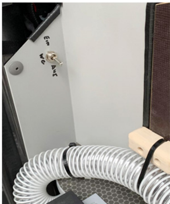
Die Ansicht durch die Hecktür mit dem Entlüftungsschlauch und Schalter für den Lüfter der ist wichtig für die Entfeuchtung.
