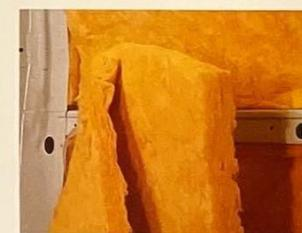
Dach und Seitenwände des James Cook sind mit 40 mm dicken Mineralwoll-Matten hervorragend isoliert; der Fahrzeugboden ist mit 25 mm dicken Dämmplatten ausgelegt.
