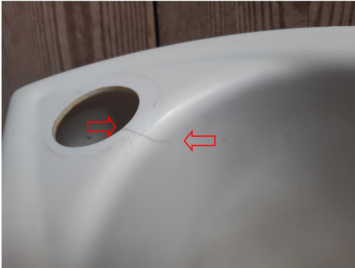
Bild 1: Riß 1 an der Stelle, wo der Hebelmischer montiert wird
