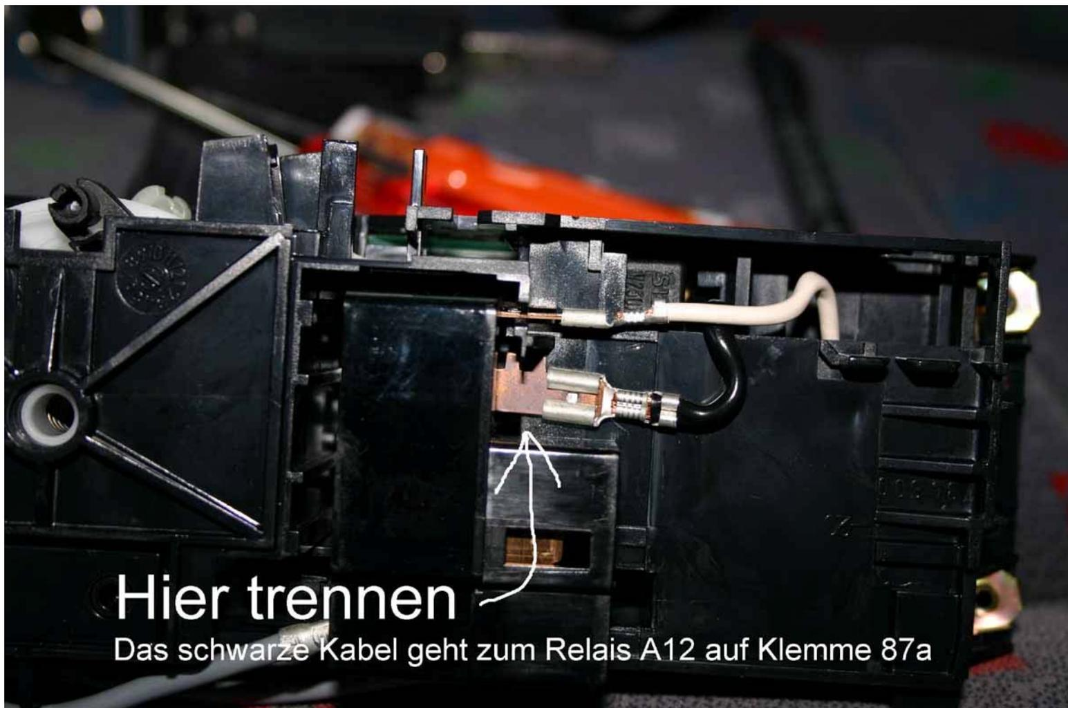
Das Relais A12 selber kann hinter der Armaturenbrettverkleidung angebaut werden.
