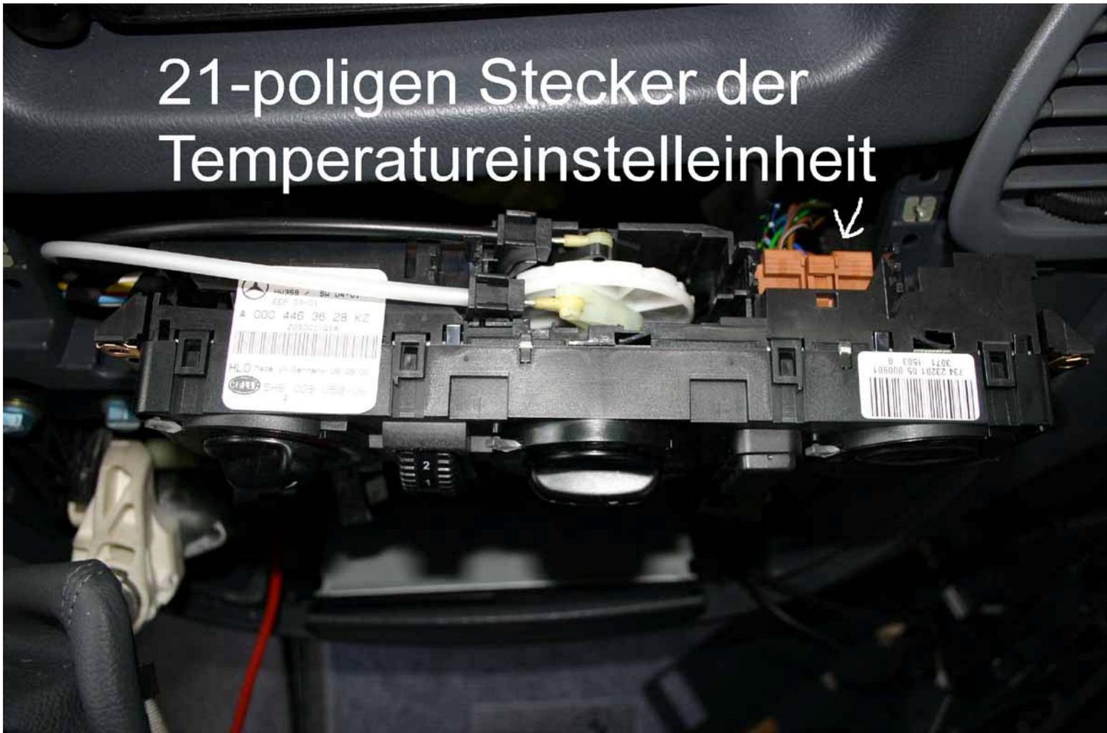
Das schwarze Kabel von der Temperatureinstelleinheit abziehen, zum Relais A12 mit Kabel 4,0mm<sup>2</sup> verlängern und dort auf Klemme 87a legen, von Relais Klemme 30 ein Kabel 4,0mm<sup>2</sup> auf den Flachsteckanschluss der Temperatureinstelleinheit stecken, von Relais A12 Klemme 86 ein Kabel zur Sitzkiste zum Knotenpunkt J8 verlegen.
