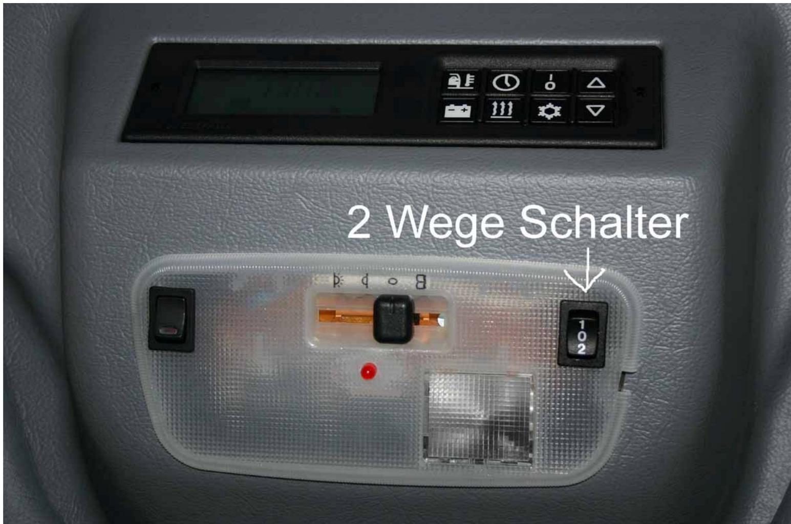
An der Westfalia-Zentralelektrik muß dazu der PIN 21 (Heizungsansteuerung), ein gelbes Kabel mit +12V (dient als Einschaltsignal) angesteuert werden.
