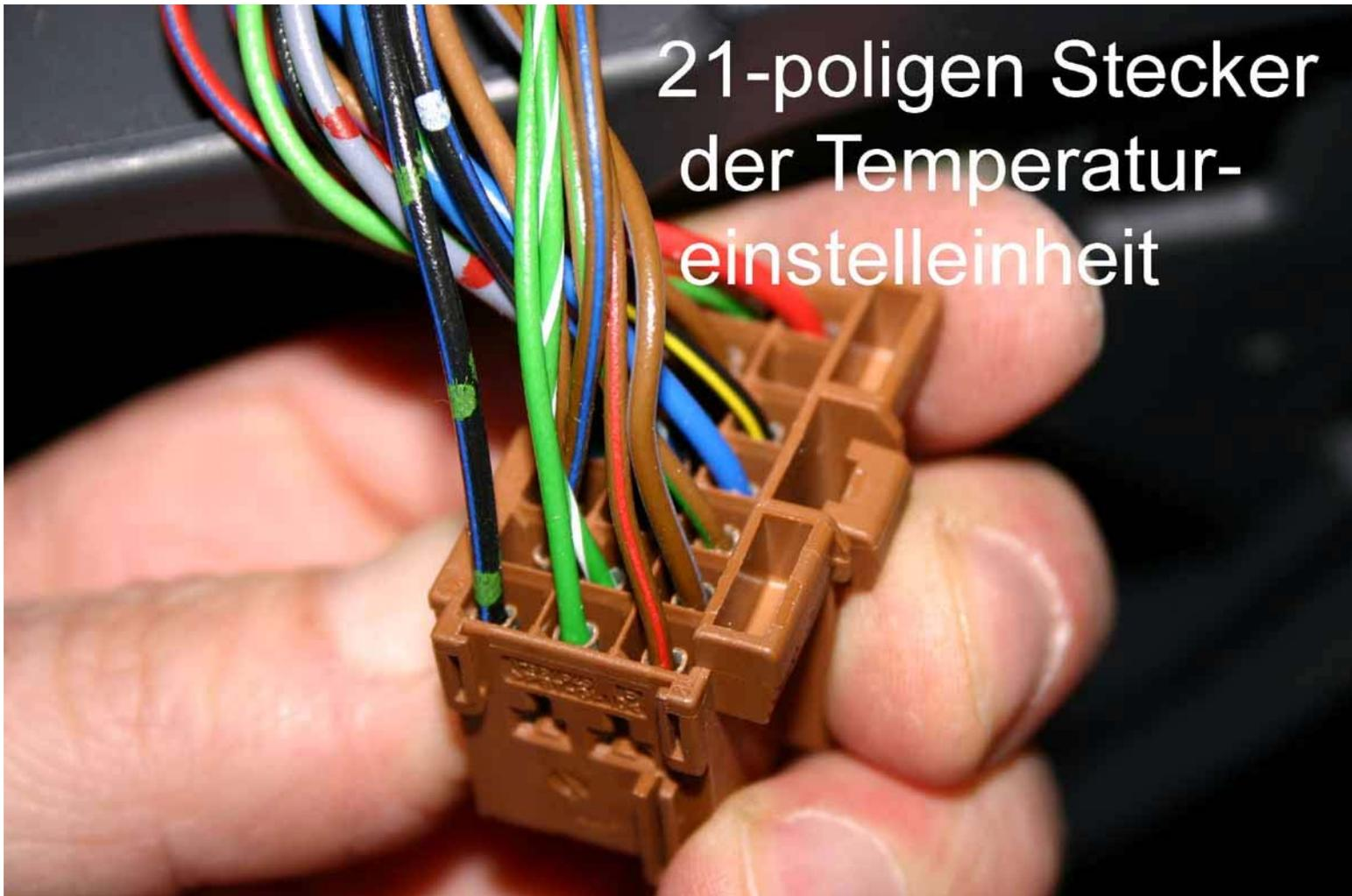
Laut Schaltplan trennen wir am 21-poligen Stecker der Temperatureinstelleinheit am PIN 2 (steuert die Umwälzpumpe-Restwärme) Kabelfarbe grn/rt die Verbindung, verlängern sie 2-polig bis zur Sitzkiste und dort an Relais A 6 Klemme 30 und 87a anschließen.
