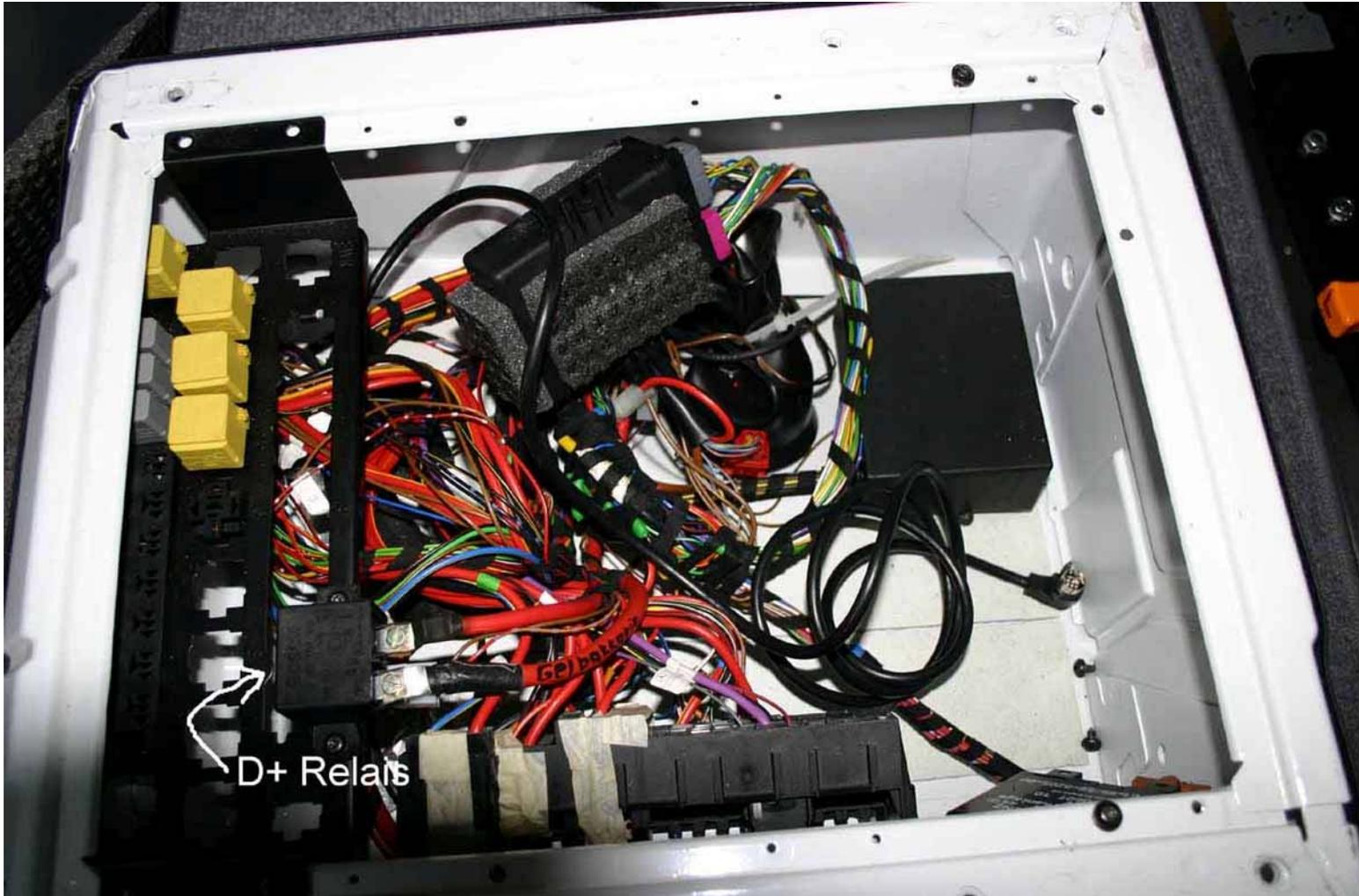
Die Relais A6, A7 und A9 sind ebenfalls im Sicherungskasten neu angelegt worden, dazu wurden Originalrelais samt Sicherungshalter und den dazugehörigen Flachsteckschuhen von Mercedes dazugekauft, der Ordnung halber.
