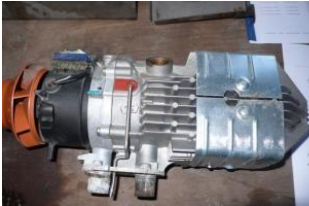
Heizung von der Seite. Links das Heizgebläse, rechts der Brenner.
