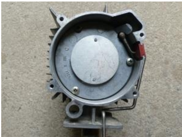
Abdeckblech wieder im Brenner verschraubt
