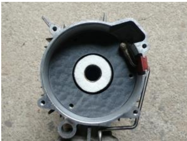
Zwei neue Dichtungen im Brenner
