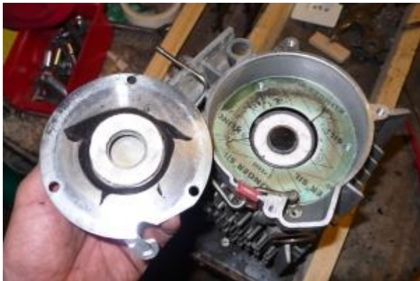
Abdeckblech vom Brenner entfernt
