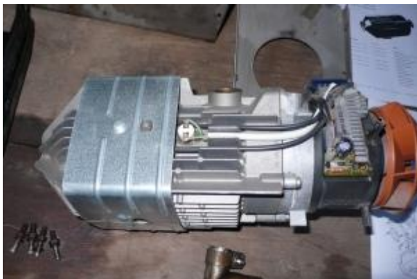
Von oben ist die Elektronik zu sehen. weiterhin noch die mit einem Sperring befestigten Bleche.
