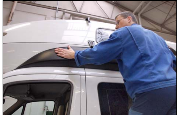
Abb.: Befestigung überprüfen
