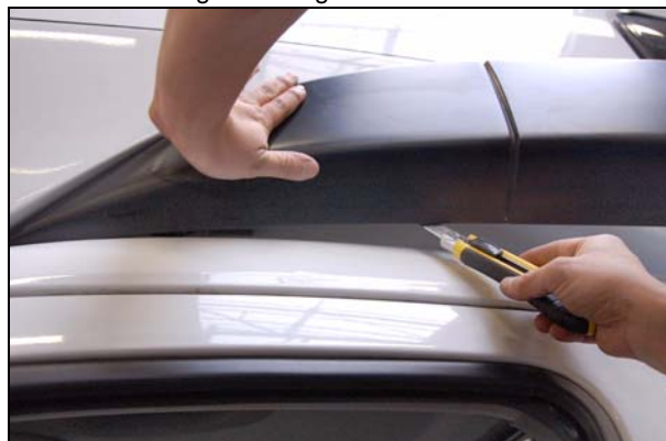
Abb.: Verklebung vorsichtig aufschneiden
