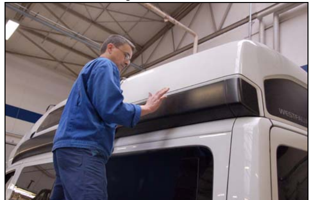
Abb.: Seitenverkleidung in die Aufnahmen drücken
