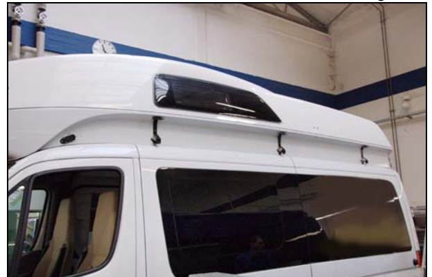
Abb.: vordere Aufnahme zum Einschieben, mit Klebung
