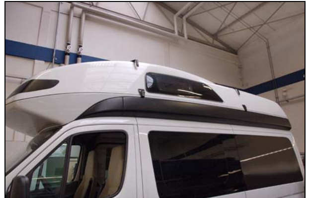
Abb.: Sitz der Spitze und damit die vordere Befestigung prüfen
