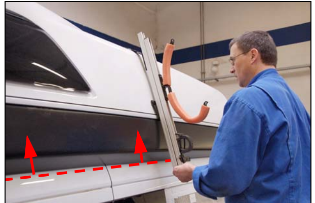
Abb.: Verbindungsstange einschieben
