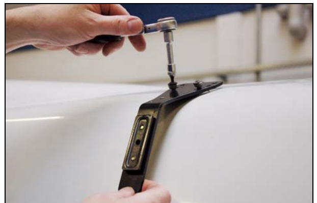
Abb.: Schrauben eindrehen und festziehen
