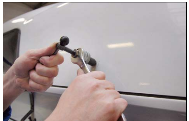
Abb.: Einnietmutter sicher vernieten
