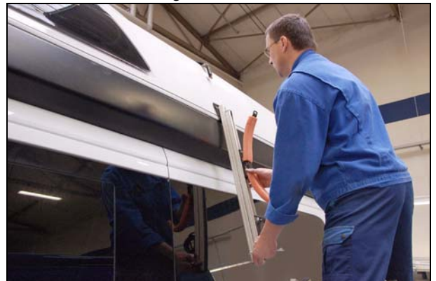
Abb.: Stangen über die unteren Kulissensteine schieben
