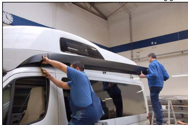
Abb.: Verklebung vorsichtig aufschneiden
