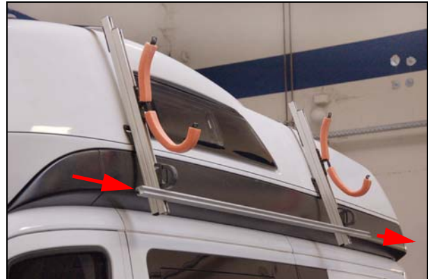
Abb.: senkrechte und Verbindungsstange ausrichten
