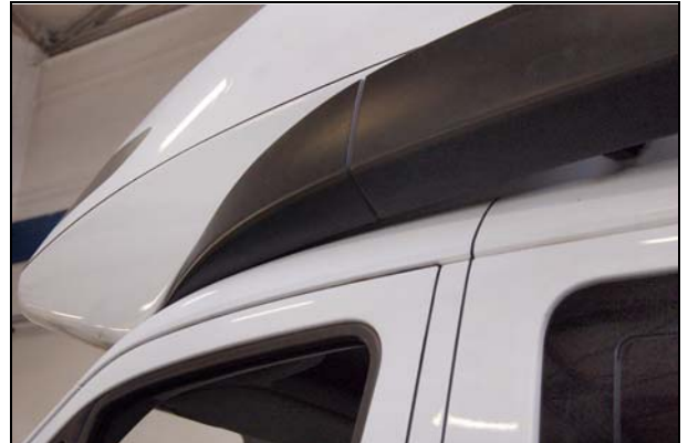
Abb.: Seitenverkleidung an das Fahrzeug schwenken
