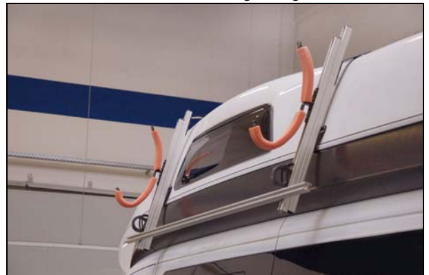
Abb.: senkrechte und Verbindungsstange ausrichten
