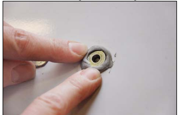
Abb.: die anderen unteren Muttern ebenfalls vernieten
