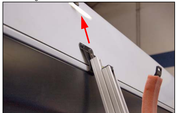
Abb.: Stangen über die unteren Kulissensteine schieben
