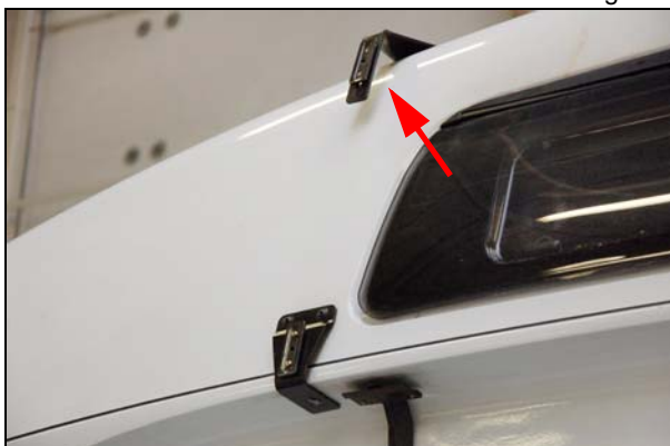
Abb.: Abstand zwischen Dach und oberer Halterung
