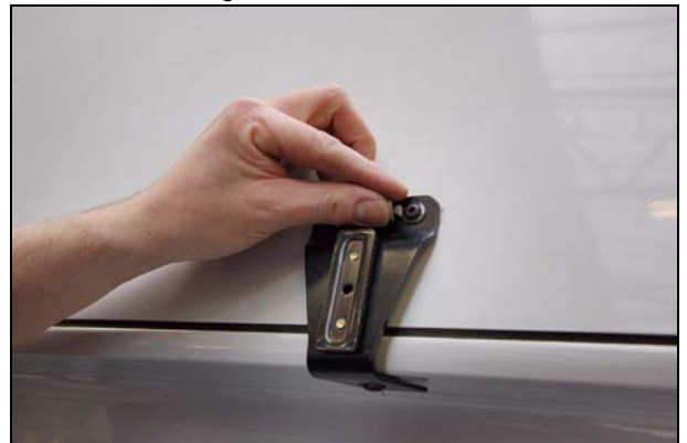
Abb.: obere Muttern vernieten und mit Dichtband versehen
