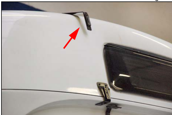
Abb.: Abstand zwischen Dach und oberer Halterung
