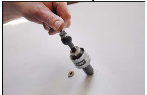
Abb.: Einnietmutter sicher vernieten
