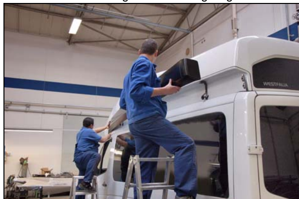
Abb.: mit einem Cutter hinter die Seitenverkleidung gehen
