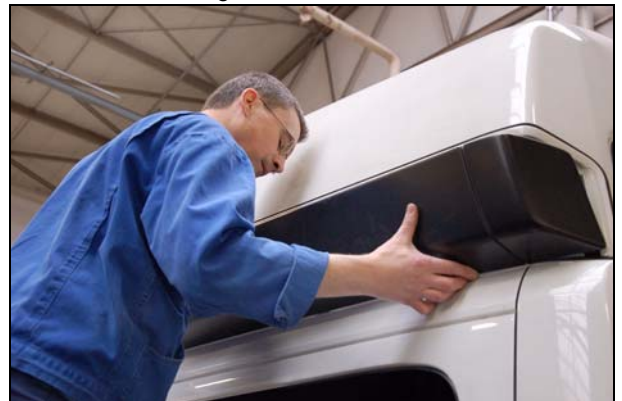
Abb.: Seitenverkleidung in die Aufnahmen drücken
