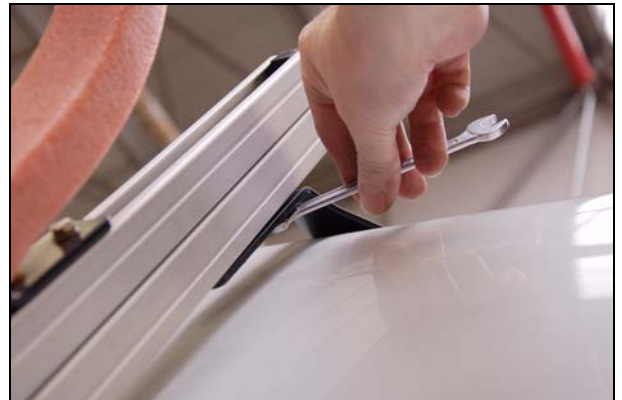
Abb.: untere Kulissensteine (auch für Verbindungstange)
