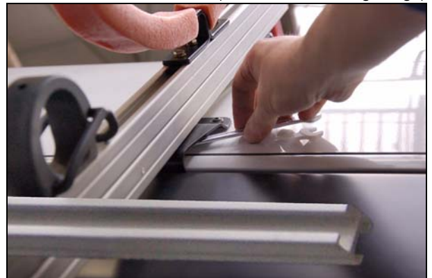
Abb.: Sicherungsschrauben eindrehen
