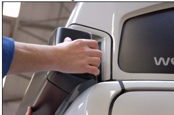
Abb.: Seitenverkleidung vom Fahrzeug weg schwenken
