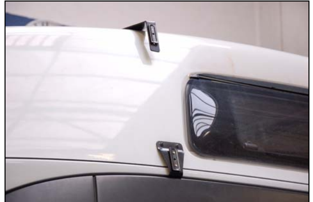
Abb.: hintere Halterungen überprüfen
