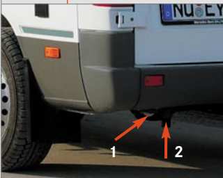
Abwassertank ca. 80 l: Entleerungsventil (1), Ablauföffnung (2)
