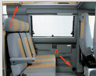
Ausströmöffnung (A) und Bedienteil der Gasheizung (B)
