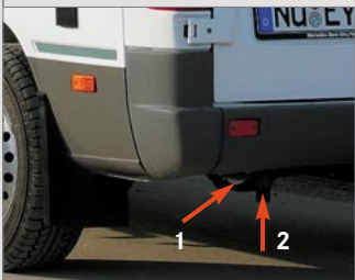
Abwassertank ca. 80 l: Entleerungsventil (1), Ablaufoffnung (2)
