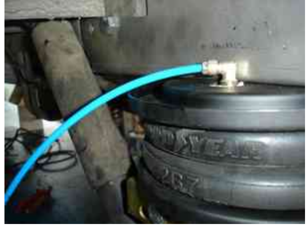
Montage der Druckluftschläuche,
