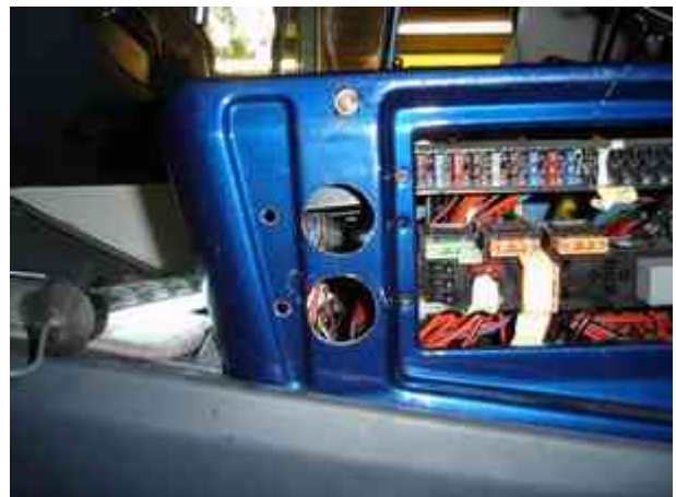
4 Löcher für die Instrumente und Ventile
