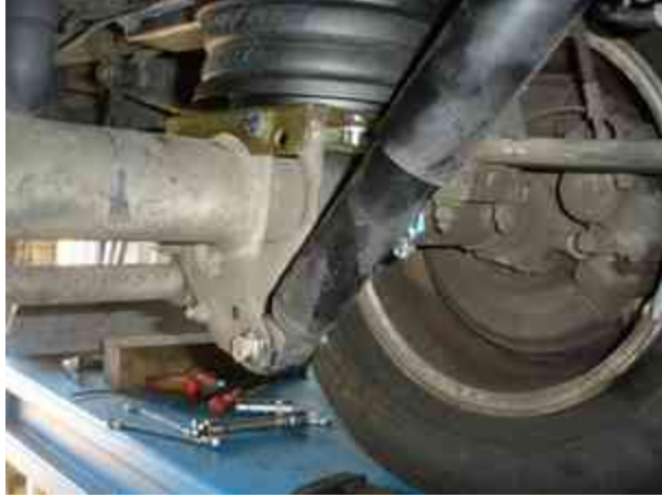
Montage des Stoßdämpfers:
