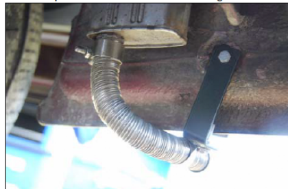
Abb.: Auspuffende mit dem Winkel befestigen
