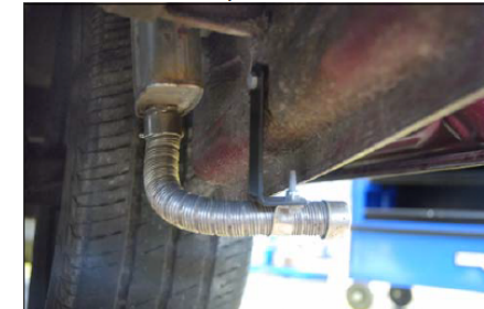
Abb.: Auspuff-Position in Längsrichtung
